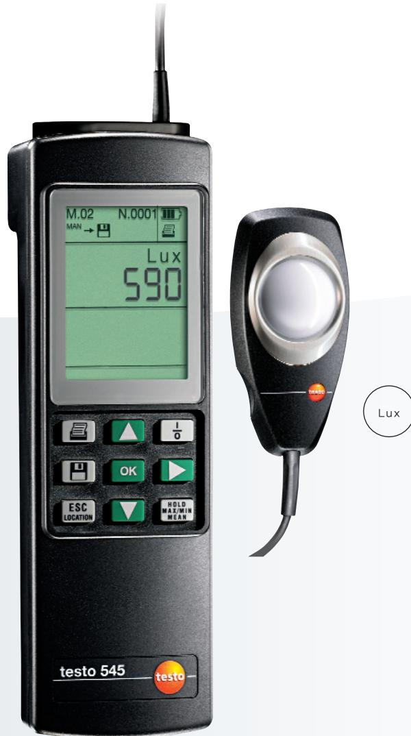
최소값을 충족해야 하는 특정 장소(작업장, 병원, 사무실, 학교, 박물관)에서 testo 545를 사용하여 효과적으로 조도를 측정하고 문서화 할 수 있습니다. 함께 공급되는 소프트웨어를 이용하여 최대 99곳의 위치를 선택하여 측정값을 저장하고, 저장된 개별 조도 측정값을 연결하여 그래프로 만들 수 있습니다. 이렇게 만든 조도 분포 곡선을 보고 조명이 균일하게 이루어지고 있는지 파악할 수 있습니다.
