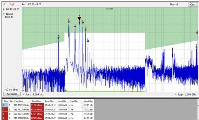
스튜어스 검색-각각 고유 한 해상도 대역폭, 비디오 대역폭, 검출기 (피크, 평균, 준 피크) 및 제한 범위를 사용하여 최대 20 개의 비 연속 주파수 영역을 정의 할 수 있습니다. 테스트 결과는 .CSV 형식으로 외부 프로그램으로 내보낼 수 있으며 최대 999 개의 위반이 보고 됩니다. 스펙트럼 결과는 선형 또는 로그 스케일로 제공됩니다.
