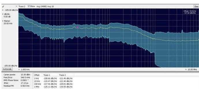
RSA5000 시리즈의 위상 노이즈 및 지터 측정 (10 월 11 일)은 전용 위상 노이즈 테스터의 필요성을 줄여 측정 비용을 절감 할 수 있습니다. 작동 범위에서 뛰어난 위상 노이즈는 많은 응용 분야에서 한계를 제공합니다. 여기서 13MHz 반송파의 위상 노이즈는 -119dBc / Hz에서 측정됩니다. 10kHz 오프셋. 이 주파수에서 <-134 dBc/Hz의 계측기 위상 노이즈는 작업에 대한 충분한 측정 마진을 제공합니다.
