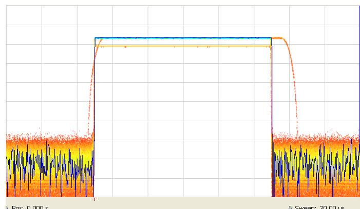
DPX Zero-span은 진폭, 주파수 또는 위상 대 시간을 실시간으로 분석합니다. 초당 최대 50,000 개의 파형이 처리됩니다. DPX Zero-Span은 모든 시간 영역 이상을 즉시 발견하여 오류 발생 시간을 줄입니다. 여기에서, 세 가지 다른 펄스 형태가 제로 스펜 진폭 대 시간으로 캡처 됩니다. 3 개의 파형 중 2 개는 10,000 펄스에서 한 번만 발생하지만 모두 DPX와 함께 표시됩니다.
