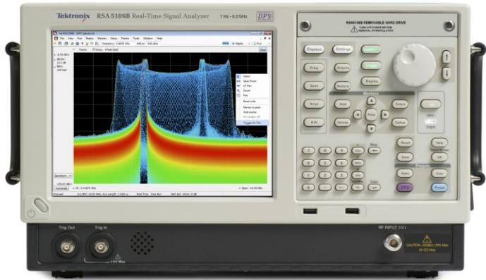
RSA5000 시리즈 실시간 신호 분석기는 기존 계측기를 대체하여 일상적인 작업에 필요한 측정 신뢰성과 기능을 제공합니다. RSA5000 시리즈는 업계 최고의 실시간 사양을 제공하며 100 % 인터셉트 확률과 최고의 실시간 동적 범위를 위한 최고의 최소 신호 지속 시간을 포함합니다. RSA5000 시리즈 장비를 사용하면 고성능 스펙트럼 분석기, 광대역 벡터 신호 분석기의 기능 및 실시간 스펙트럼 분석기의 고유 한 트리거 캡처 분석 기능을 모두 단일 패키지로 얻을 수 있습니다.
