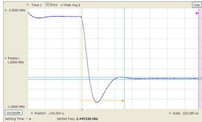
정착 시간 측정 (10 월 12 일)은 쉽고 자동화됩니다. 사용자는 측정 대역폭, 공차 대역, 기준 주파수 (자동 또는 수동)를 선택하고 통과 / 실패 테스트 시간에 대해 최대 3 개의 공차 대역을 설정할 수 있습니다. 안정화 시간은 외부 또는 내부 트리거와 마지막으로 설정된 주파수 또는 위상을 기준으로 할 수 있습니다. 그림에서 서호핑 발진기의 주파수 안정화 시간은 테스트 대상 장치의 외부 트리거 지점에서 측정됩니다.
