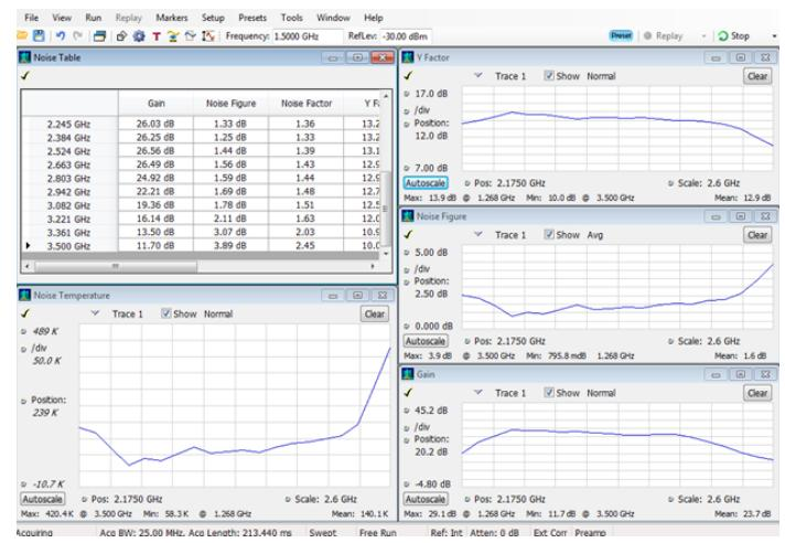
노이즈 피거 및 게인 측정(옵션 14)을 통해 RTSA 및 노이즈 소스를 사용하여 장치를 빠르고 쉽게 측정 할 수 있습니다. 이 이미지는 잡음 온도, 게인, 잡음 지수 및 Y- 인자 그래프가 있는 측정 요약 표를 보여줍니다.
