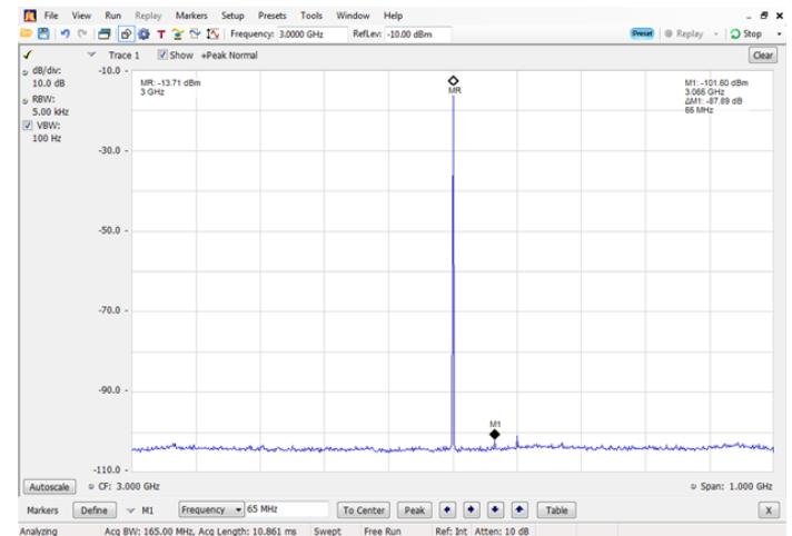
광대역, 높은 동적 범위 옵션 (B85HD, B125HD 및 B16xHD)은 비교할 수 없는 실시간 스펙트럼 분석 동적 범위를 제공합니다. 16 비트, 200MS / sec 디지타이저 2 개가 인터리브 되므로, 시판되는 다른 계측기 보다 -10dBc의 일반적인 스피리어스 프리다이나마 레인지가 최대 -80dBc 인 400MS / sec 획득이 가능합니다. 여기서 3GHz의 신호는 -13.71dBm에서 측정되며, 디지타이저의 가장 큰 스피리어스 신호는 캐리어 아래 -87.89dB입니다.
