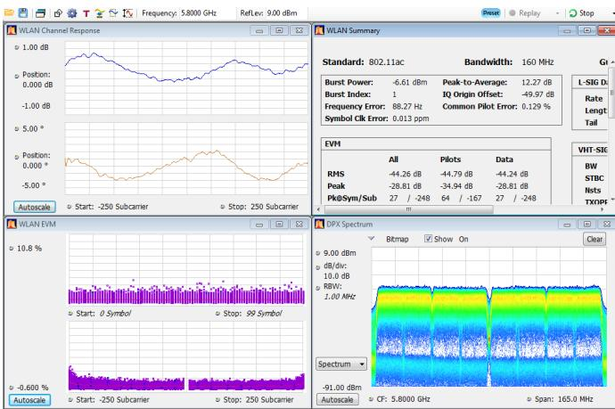
802.11 표준에 대한 분석 옵션을 사용할 수 있습니다. 여기서, 802.11ac 160 MHz 대역폭 신호는 EVM 대 서브 캐리어 번호 및 심벌 번호, WLAN 응답의 요약을 갖는 채널 응답 대 서브 캐리어 및 분석 된 신호의 DPX 스펙트럼의 디스플레이로 분석됩니다. -44.26dB의 EVM 및 기타 신호 측정 값이 요약 패널에 표시됩니다.
