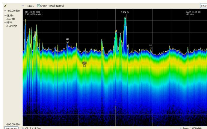
Swept DPX는 실시간 대역폭보다 넓은 범위에서 확률이 낮은 이벤트를 캡처 할 수 있습니다. 여기서 1GHz 스윕은 무선 안테나에서 1.9GHz ~ 2.9GHz의 활동 형태를 보여줍니다. 1.9 GHz 셀 밴드의 숫자 신호가 보이며 2.4 GHz ISM 밴드의 중요한 활동이 분명합니다. 밀도 측정은 중앙 근처에서 가장 큰 신호에 사용되어 대략 3.5 %의 점유율을 나타냅니다.
