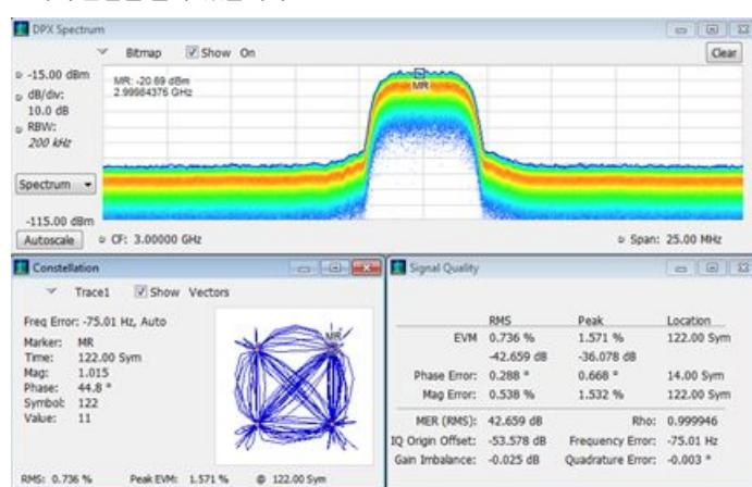
여러 도메인에서 시간 관련보기는 기존 분석기로는 불가능했던 설계 문제에 대한 새로운 통찰력을 제공합니다. 여기에서 변조 품질 및 성상도 측정은 DPX® 스펙트럼 디스플레이의 지속적인 모니터링과 결합됩니다.
