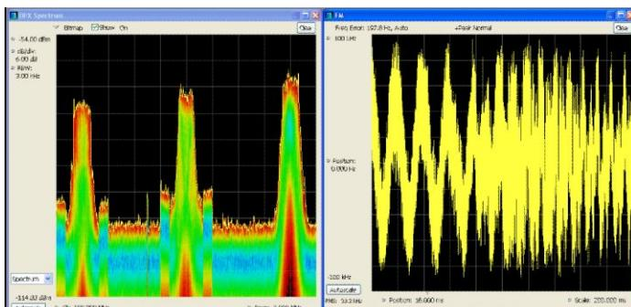
오디오 모니터링 및 변조 측정은 동시에 스펙트럼 관리를 보다 쉽고 빠르게 수행 할 수 있습니다. 여기에서 DPX 스펙트럼 디스플레이는 관심 있는 신호의 라이브 스펙트럼을 보여 주며 동시에 복조 된 오디오를 내부 악기 라우드 스피커에 제공 합니다. FM 편차 측정은 동일한 신호에 대해 디스플레이 오른쪽에 표시됩니다.
