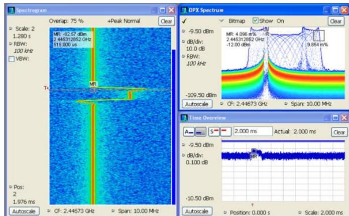
트리거 및 캡처 : DPX Density™ 트리거는 주파수 도메인의 변화를 모니터링하고 위반 사항을 메모리에 캡처 합니다. 스펙트로그램 디스플레이 (왼쪽 패널)는 시간에 따른 주파수 및 진폭 변화를 보여줍니다. 스펙트럼 위반이 DPX Density™ 트리거를 트리거 한 스펙트로그램에서 특정 시점을 선택하면 주파수 도메인보기 (오른쪽 패널)가 자동으로 업데이트되어 정확한 순간에 세부적인 스펙트럼보기가 표시됩니다.
