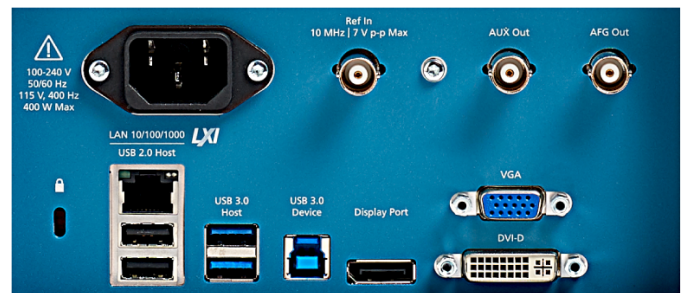
6 제품군 MSO 를 나머지 설계 환경에 연결하는 데 필요한 I/O.
