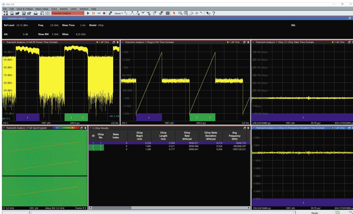
그림 4 : R & S® VSE-K60c 과도 분석 옵션으로 처프 시퀀스 신호의 과도 분석. 펄스 전력 대 시간은 왼쪽 상단에 표시됩니다. 선형 주파수 응답은 상단 중앙과 하단 하단의 스펙트럼 그래프에서 볼 수 있습니다. 소프트웨어는 감지된 펄스의 특성을 테이블 (아래 가운데)에 나열합니다. 그래픽 형식으로 속성을 자세히 조사 할 수도 있습니다. 처프 속도와 주파수 편차가 오른쪽에 표시됩니다.
