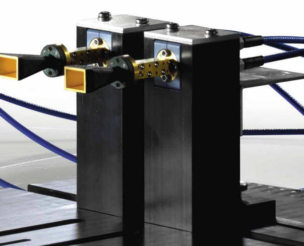
그림 1 : 오실로스코프를 사용한 다중 채널 레이더 분석을 위한 테스트 설정. 레이더 신호는 고주파 믹서에 의해 3GHz의 IF 주파수로 다운 컨버전 되어 오실로스코프에 공급됩니다. 하나의 채널만 있는 테스트 설정에는 전력 분배기와 하나의 믹서가 필요하지 않습니다.
