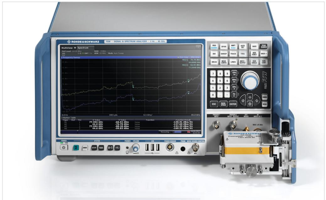
그림 5 : R & S®HA-Z24E 외부 프리앰프가 있는 R & S®FSW85 신호 및 스펙트럼 분석기 (1 ~ 85 GHz)
