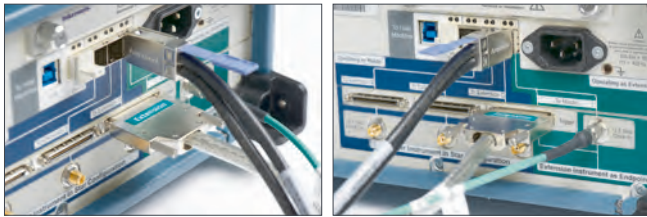
UltraSync 케이블에 의한 멀티 채널 연결 왼쪽이 마스터, 오른쪽이 익스텐션
