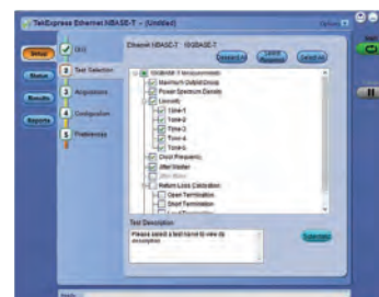
10GBASE-T, NBASE-T(2.5GBASE-T and 5GBASE-T) 및 IEEE802.3bz(2.5G/5G)의 자동 적합성 테스트
