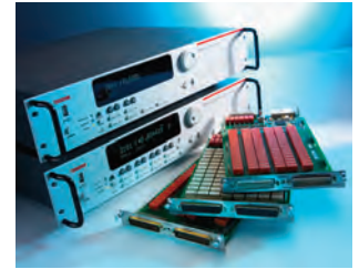
다채널 측정용 DAQ6510(상)과 3706A(하) 3706A에 탑재된 TSP-Link에 의해 2600 시리즈와 간단하게 통신
