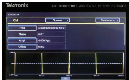
AFG31000에서 InstaView OFF 시의 스크린 설정한 사각파를 표시하고 있으며 실제 DUT에서의 파형과는 다름
