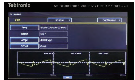
AFG31000에서 InstaView ON 시의 스크린 오실로스코프에서 관측한 파형과 동일한 파형을 실시간으로 표시
