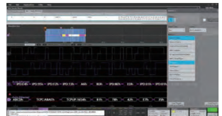
차량용 Ethernet 1000BASE-T1/100BASE-T1 적합성 테스트 및 디버그, 100BASE-T1의 Tx/Rx 신호 분리, PAM3 해석
