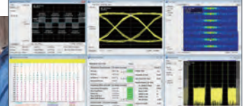
옵션인 SV27에 의해 Bluetooth의 Basic Rate/EDR/Low Energy의 해석 가능
