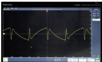
오실로스코프상의 파형 사각파를 DUT에 입력하고 있지만 임피던스 불일치로 파형이 왜곡되어 있음
